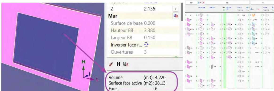
Pour un mur béton, on mesurera le volume de béton, les surfaces de coffrage, le tonnage d'armature et peut-être encore le genre de finition ou de traitement spécial (talochage, adjuvant). Voici les étapes principales :
