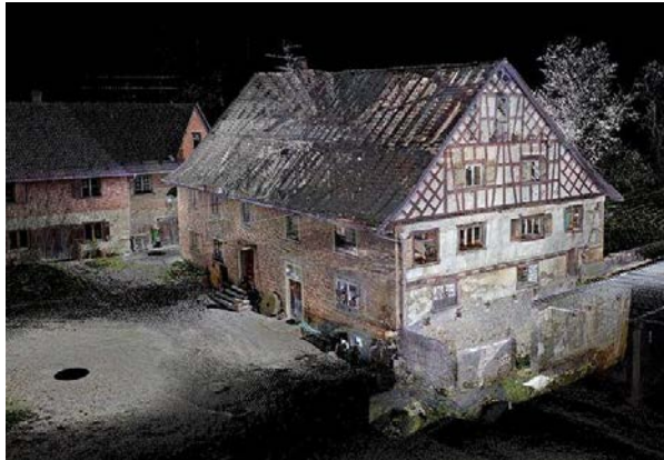
Relevé par nuage de points, le laser a été placé à l'emplacement du rond noir
