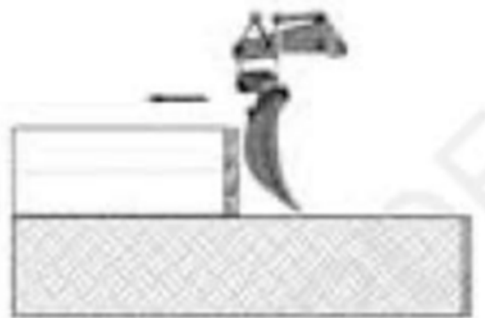
Emboîtement des tubes à l'aide d'une pelle hydraulique
