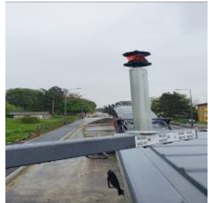
Photo : Prisme sur fraiseuse EPALINGES/RC601 (REPROAD)
